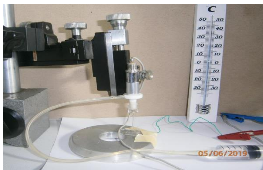
Снимка 3. Лабораторна установка за капково микропипетна техника.
